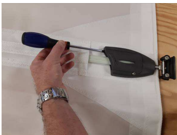
Régalez légèrement la tension avec la vis sans fin du boîtier à l'aide d'un tournevis.
