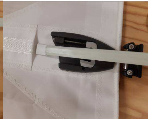
Introduisez la latte dans le gousset bien droite et sans forcer
