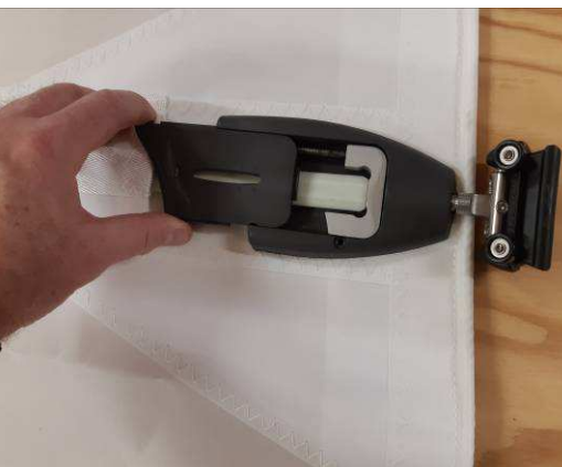
Reglissez le capot du boîtier bien à fond
