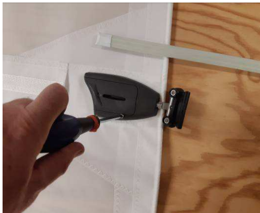
Dévissez la vis retenant le capot du boîtier fermé
