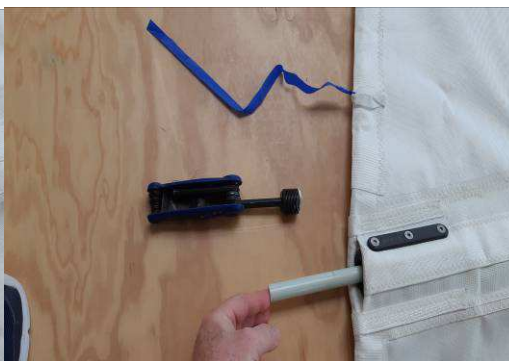
Glissez la latte dans le gousset bien droite et en butée dans le boîtier de guindant
