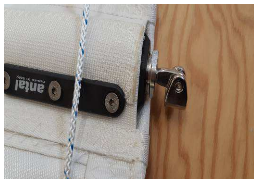
Et vissez ensuite le bouchon inox dans le boîtier sans forcer
