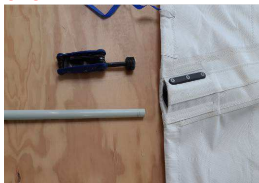
Démontez le bouchon du boîtier de chute (Clé 6 pans)
